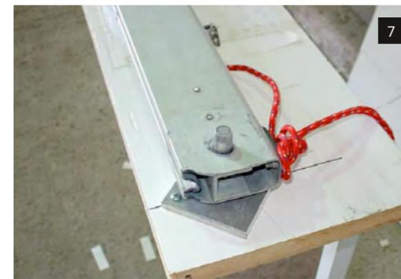
Взвесьте мачту (см. рис. 5) и проконтролируйте высоту ЦТ относительно шпора, используя клиновую опору (рис. 6).
