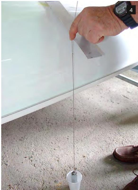
Используя металлический угольник с длинной полкой, а лучше прецизионную откидную линейку (рейсшину) и отвес наносим точки обмерных сечений на линию борта в соответствии с боковой маркировкой «продольного бруса». Данные точки используются для выставки шаблонов корпуса и последующего обмера кокпита.
