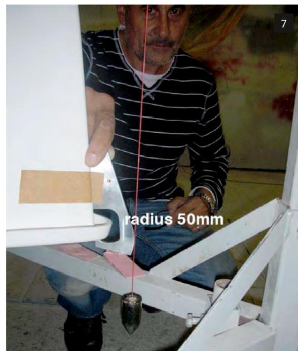
для правильной установки шаблона, с тем, чтобы линия борта лежала в поле допуска, а зазор не превышал 10 мм. Смотри рисунок из раздела D.9.1 — «Обмер формы корпуса по шаблонам», страница 26 (в оригинале ошибочно указана страница 24). «Правил класса «Финн».
