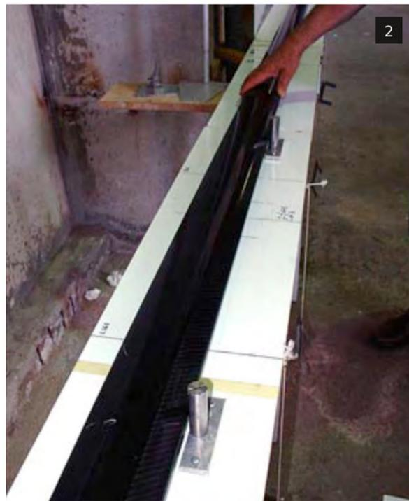
Установите шаблон для отверстия вилки крепления гика (рис. 3) для контроля положения отверстия согласно F.2.6.
