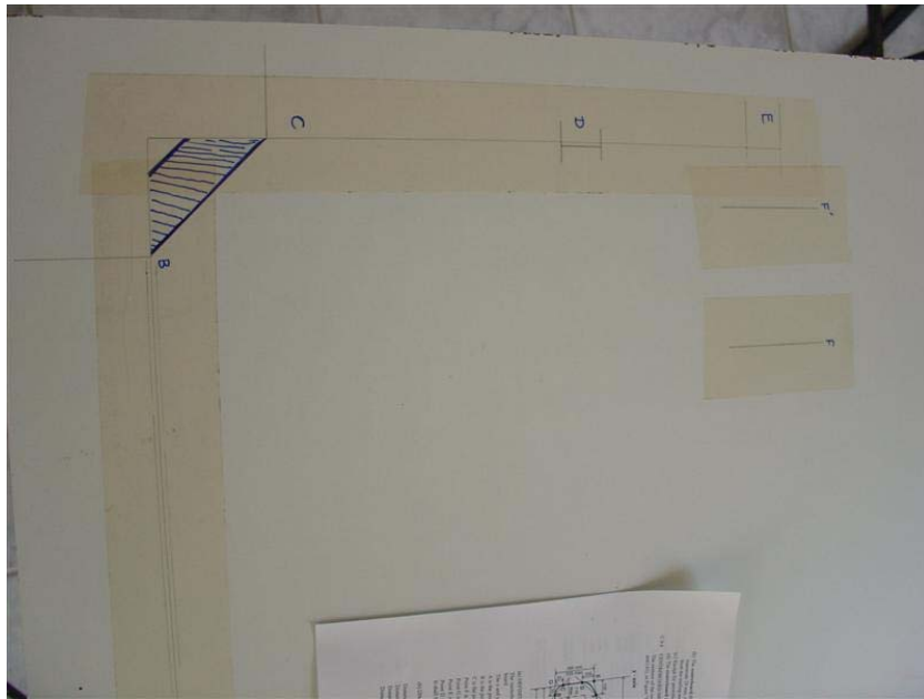
Fig. 10 Bottom edge of centerboard template
